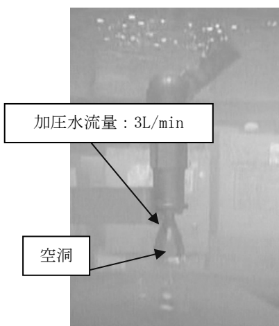
図 4-14 パラソルノズルの空洞形成 (水中)
